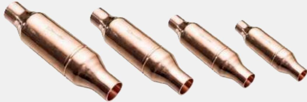
CVS型紫铜膜片单向阀采用紫铜管全密封阀体、过滤网、磁性、覆PTFE膜膜片自吸结构设计，从而使单向阀不受安装角度限制和反向压力大小的关系影响阀门的自动闭合，具有极小的流通阻力，流量大，逆向近乎零泄漏。
